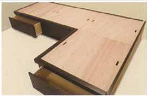
(7) 中蓋の取付け
