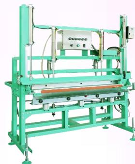
接着畳と框を縫着した畳、どちらも折り曲げが可能で、床裏面への折り曲げもでき、綺麗な仕上がりにできます！
